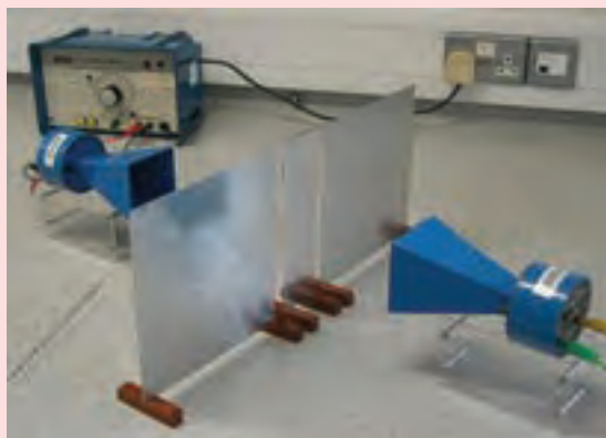
الف) اسباب آزمایش دو شکافی برای موج الکترومغناطیسی میکروموج
